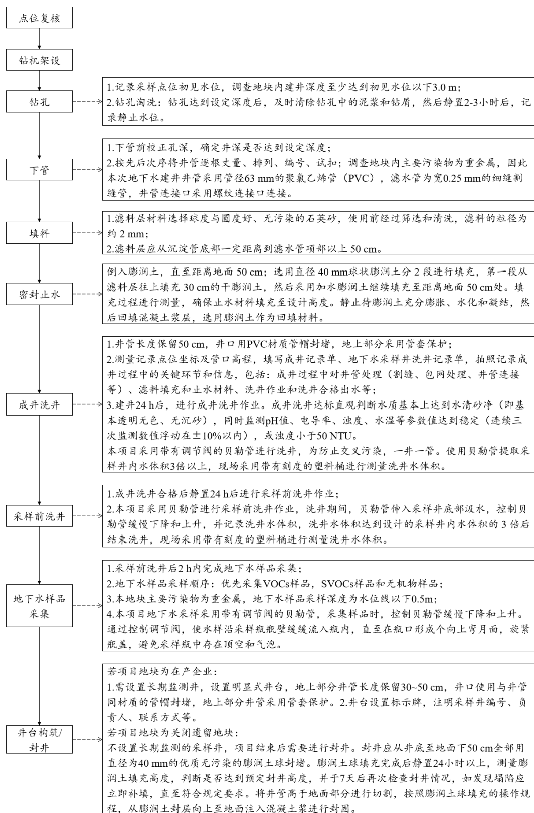
图 7.1-1 地下水采样井建井及采样流程
